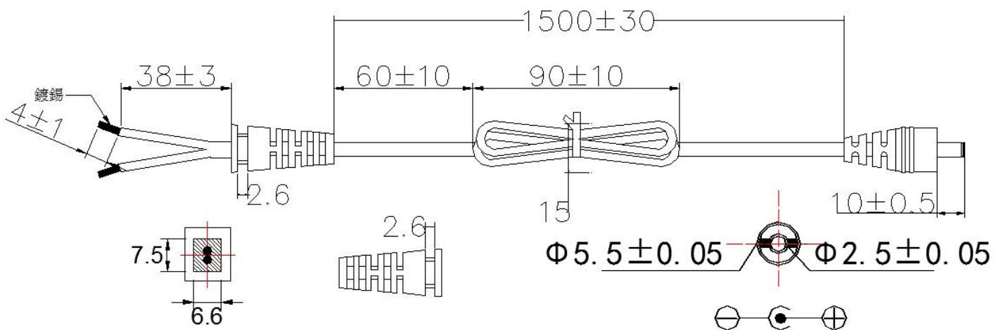
注: DC输出线 UL2464 18AWG 1500mm
